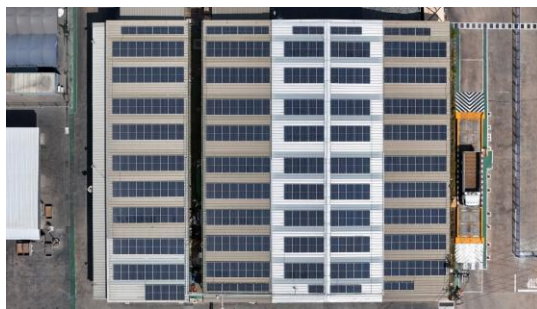
ภาพที่ 2.2-38 แผงเซลล์แสงอาทิตย์ (Solar Module) บนหลังคา (Roof Mounting) ของอาคารผลิต
